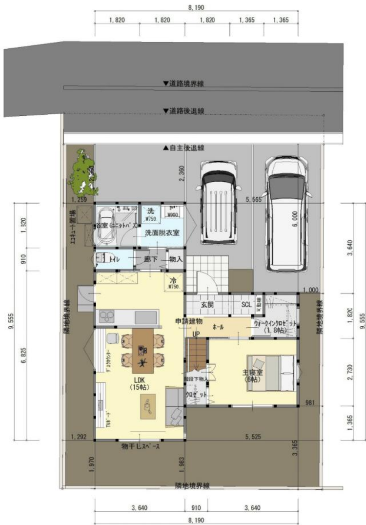
■配置図兼1階平面図
